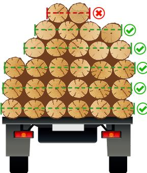
Se realizan las mediciones (en metros) del ancho del bloque de la carga del vehículo; posteriormente se calculan los promedios de los anchos. **Considerar NO tomar aquellos anchos del bloque, en donde se encuentren pocas trozas apiladas.**
