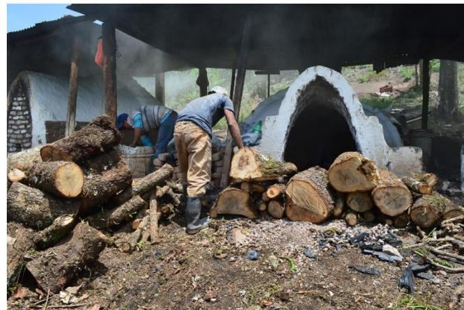
Se estima que para poder llenar un horno semi industrializado se utilizan de uno a dos árboles grandes (DAP  $>35 \text{ cm}$ ) o de 3-5 medianos (DAP  $\sim 15\text{-}30 \text{ cm}$ ); por cada horno pueden obtenerse de 11–15 costales de carbón, con una eficiencia entre el 75-85% del volumen original. El costal de carbón tiene un costo local de Q80.00 – 150.00 y con embalaje de tipo bolsa, de capacidad de 5 lb, tiene un precio de Q5.00 – 10.00.
